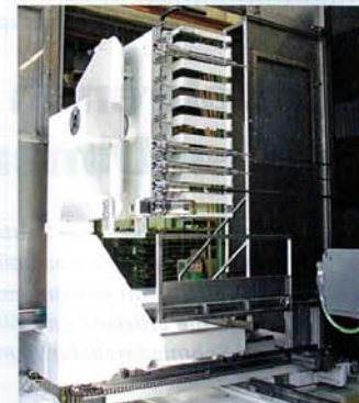
Eine Spindel für beide Operationen reduziert das Kollisionsrisiko und vereinfacht die Programmierung: Im linken Bild ist die Spindel fürs Tiefbohren zurückgefahren, im rechten befindet sie sich in Fräsposition
