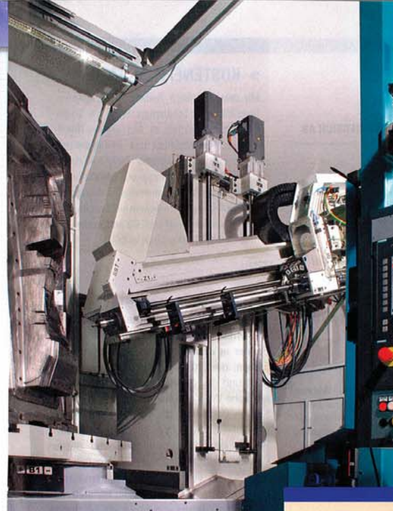
Eine Spindel für beide Operationen reduziert das Kollisionsrisiko und vereinfacht die Programmierung: Im linken Bild ist die Spindel fürs Tiefbohren zurückgefahren, im rechten befindet sie sich in Fräsposition
