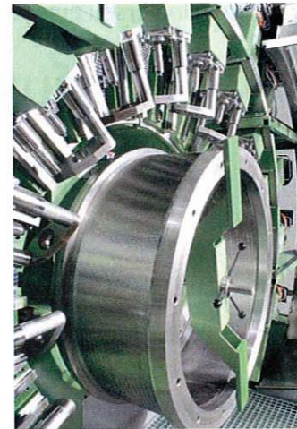
Beim Bohren werden Spitzenwerte von 1000 mm/min erreicht
