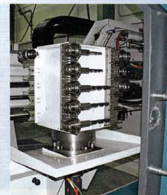
Der vollautomatische Wechsler für die Tiefbohr-Werkzeuge nimmt zehn Einlippenbohrer auf und ermöglicht den mannos Betrieb
