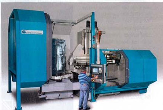
Das Tiefbohr-Fräs-Zentrum BW250-S zerspannt beim Fräsen bis zu 250 cm 3 Stahl pro Minute und bohrt in einem Zug bis 1500 mm tief. Bilder: TBT
