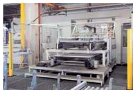
图 3 机床后部的上料单元具有良好的通路，能够方便送入和取出组件
