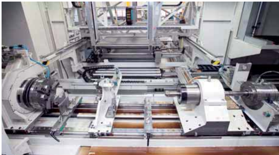
图 1 ML500 型机床内部视图，后部为全自动上料单元
