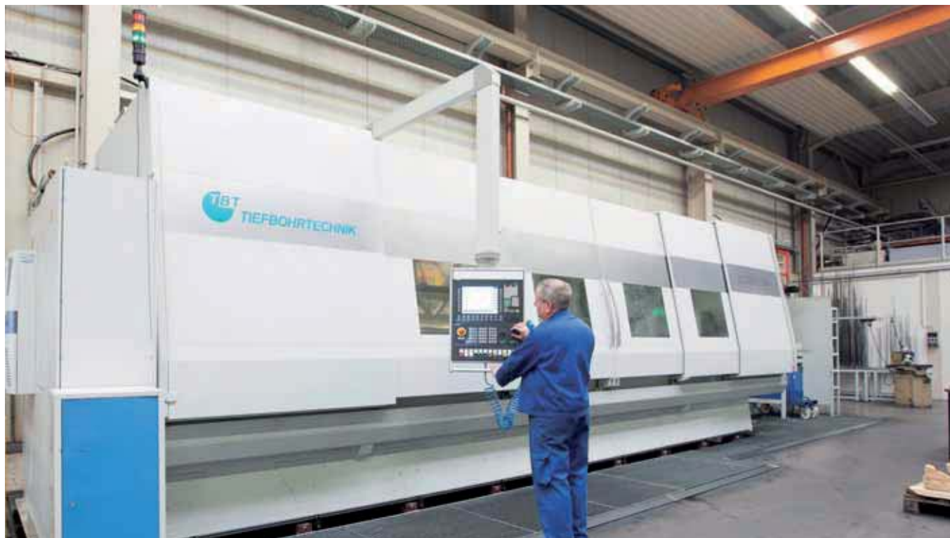
位于开姆尼茨的 GLUMANN Maschinenbau 的 ML500 型 TBT 深孔钻机床，该机床采用 BTA/STS 技术，主要用于直径达 80 mm，深度达 2000 mm 的钻孔
