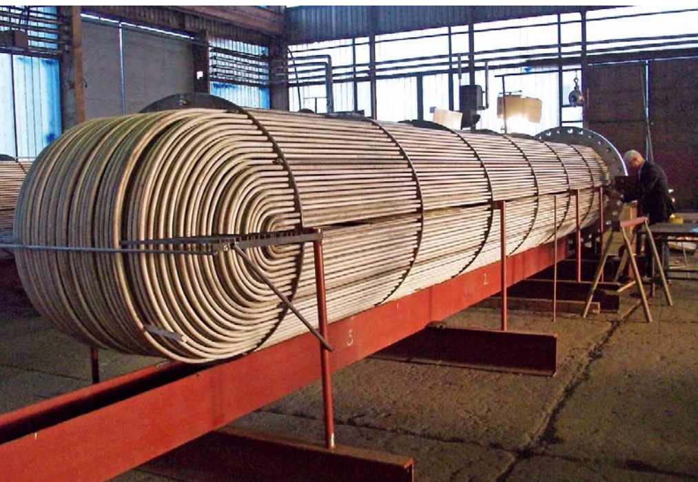
Alles im „Energie“-Fluss: Rohrbündel-wärmetauscher verfügen über eine Vielzahl von parallel angeordneten Rohren, durch die ein Medium fließt, während das andere Medium außen an diesen Rohren vorbei strömt. Bild: Burkhard & Weber
