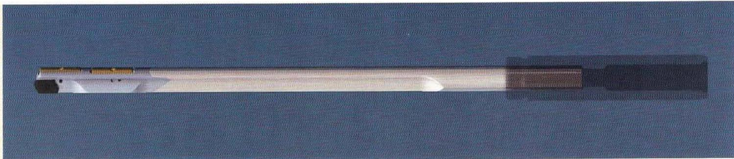
Für komplexe Arbeitsaufgaben kommen TBT-Wendeschneidplattenbohrwerkzeug mit mehreren Führungsleisten infrage.
