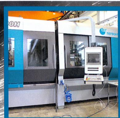
Die neue BW200H von TBT bietet vollautomatisches Tieflochbohren bis 1000 mm und die Fräsleistung eines mittleren Bearbeitungszentrums.
