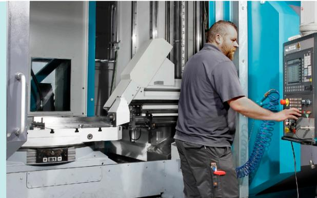
Auf unseren Bohrwerken bearbeiten wir Ihre Teile bis zu einem Gewicht von 5 t. Der Bohrdurchmesser kann 1 - 40 mm betragen. Platten können bis zu einem Schwingkreis von 2,8 m in einer Aufspannung von 4 Seiten bearbeitet werden. In einem Zug können Bohrtiefen bis zu 1500 mm eingebracht werden.
