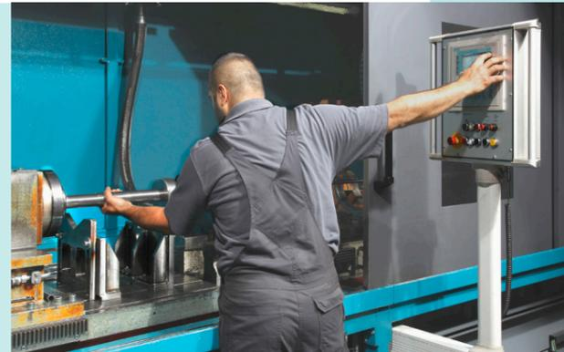
Größere Bohrdurchmesser bis 75 mm werden auf unseren Maschinen im BTA/STS-Verfahren hergestellt.
